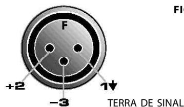
PINAGEM DATOMADA MIC-XLR NORMA IEC 268
